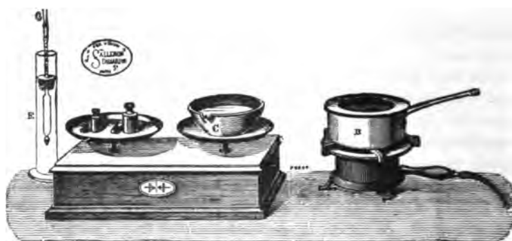
Fig. 271. — Dispositif pour le procédé par réduction de François.
